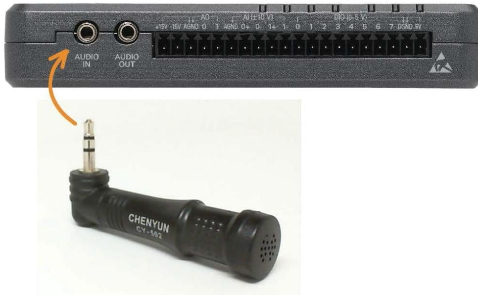
Figura 10.2: Circuito demostrativo para micrófono electret conectado directamente a AUDIO IN.
