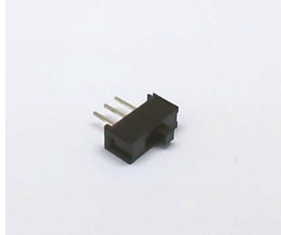
Figura 4.3: Interruptor SPDT (un polo un tiro) incluido en el Paquete de Inicio para NI myRIO.
