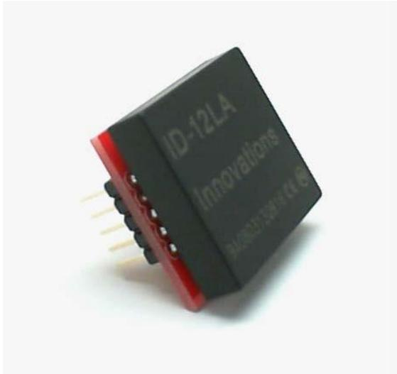
Figura 38.2: Lector RFID, tarjeta de conexión y conectores planos después de soldar.
