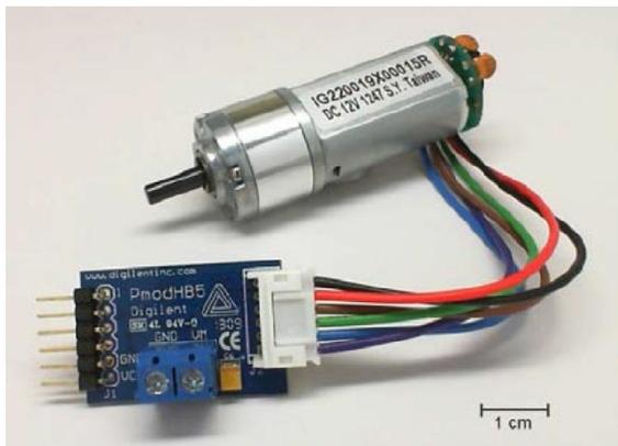
Figura 18.1: Puente H y motorreductor del Juego de Accesorios para Mecatrónica de NI myRIO.
