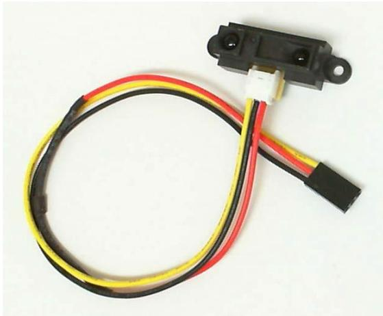
Figura 19.1: Telémetro IR del Juego de Accesorios para Mecatrónica de NI myRIO.
