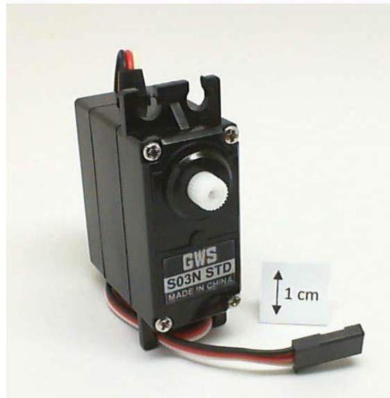
Figura 17.1: Servo del Juego de Accesorios para Mecatrónica de NI myRIO.
