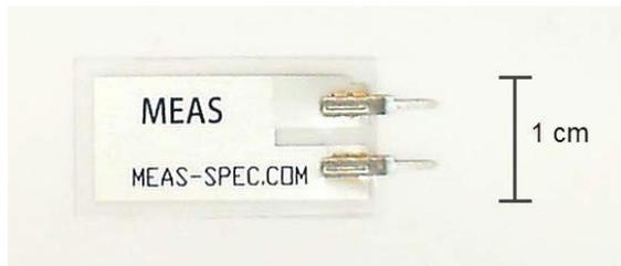
Figura 16.1: Sensor piezo del Paquete de Inicio para NI myRIO.
