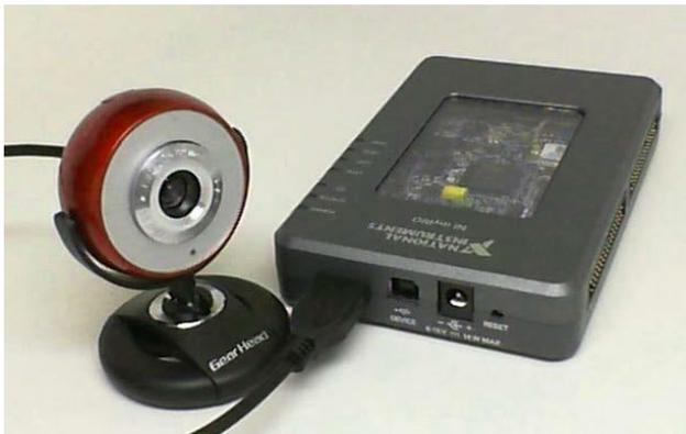
Figura 36.1: Cámara web conectada al puerto USB de NI myRIO USB.
