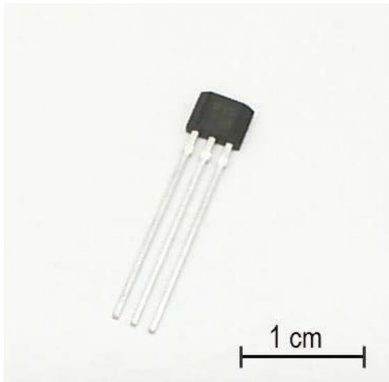
Figura 15.1: Sensor de efecto Hall del Paquete de Inicio para NI myRIO.
